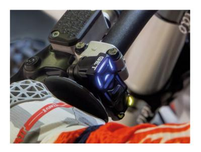
La gamma SX1 PRO è completata degli accessori recentemente introdotti: l'LC-GPA (per monitorare il corretto regime di giri motore prima di scattare dal cancelletto e il livello di controllo di trazione) ed il GPA Switch (per selezionare meccanicamente il livello di controllo di trazione che si adatta meglio al pilota).
